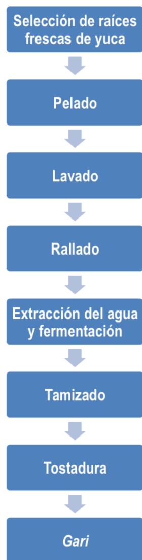
Gráfico 1. Diagrama de flujo de la producción de gari
