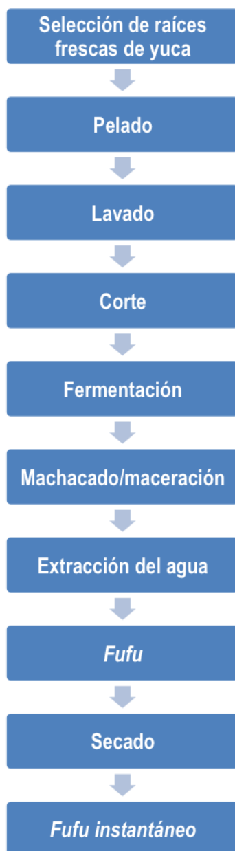
Gráfico 2. Diagrama de flujo de la producción de fufu/fufu instantáneo
